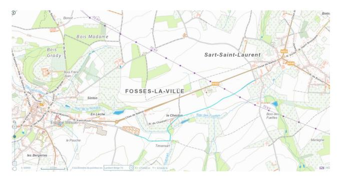
La section à aménager mesure environ 1.800 m. Vu les nombreux accès aux champs rencontrés, il est nécessaire de permettre aux agriculteurs d'utiliser ces chemins. C'est pourquoi la Ville propose un aménagement bi-bandes en béton.
